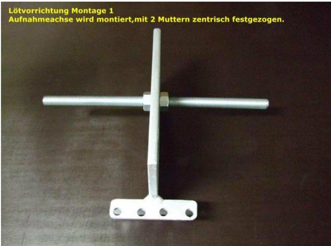
Als erstes wird die Montageachse durch den Grundkörper gesteckt. Diese wird mittig ausgerichtet und mit zwei Muttern festgezogen.
